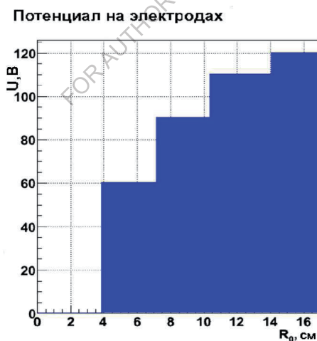
Рис. 3.12. Распределение потенциала по радиальным электродам в выстреле.
