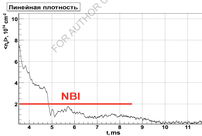
Рис. 3.20. Линейная плотность мишени плазмы при заземлении радиальных электродов
